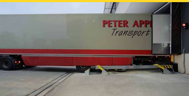
Przyczepy z osłonami bocznymi i niewielkim prześwitem.
