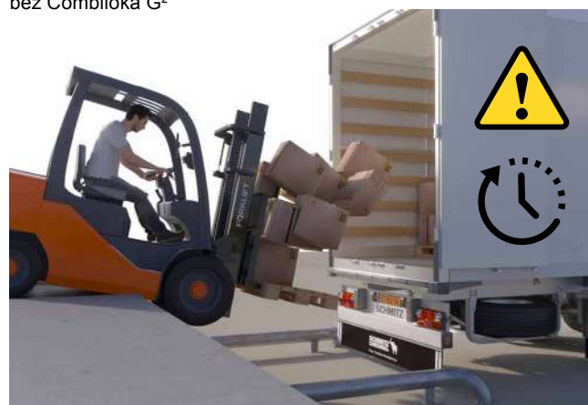
Ryzyko przedwczesnego odjazdu kierowcy bez zabezpieczenia Combilok G 2
