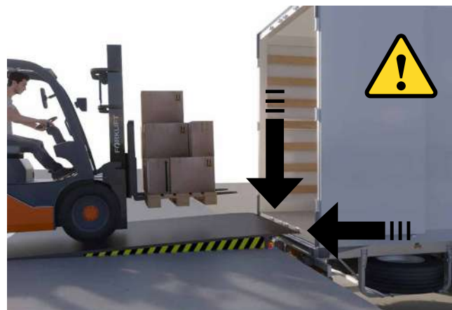
Ryzyko niekontrolowanego “przemieszczania się” pojazdu bez Combiloka G 2
